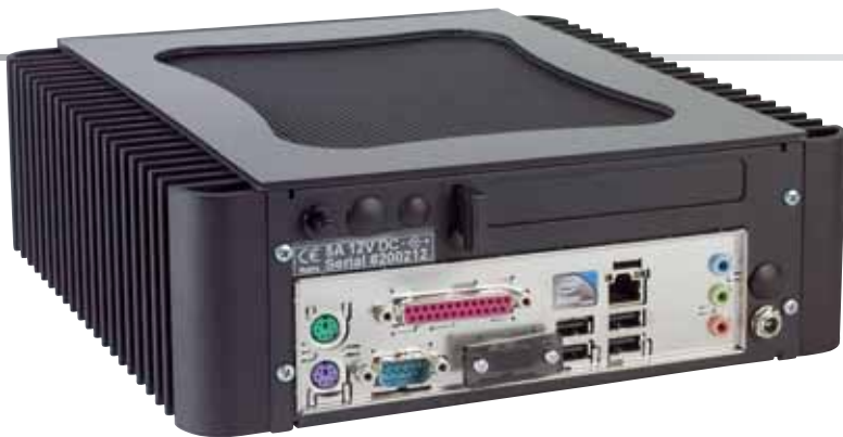
Sicher, das ist ein PC, der auch einen Tastaturanschluss und eine Buchse für die Maus bereithält. Brauchen wir aber nicht, uns interessieren nur die USB-Buchsen und Ethernet
