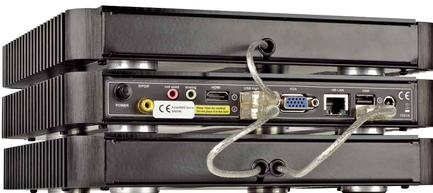
Während das AssetNAS DSD selbst von einem externen Netzteil mit Strom versorgt wird, beziehen die Zusatzgeräte ihren Strom vom Server
