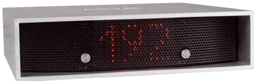
Die detektierte Abtastrate wird im Matrix-Display groß und für jeden auch vom Weitem erkennbar angezeigt
