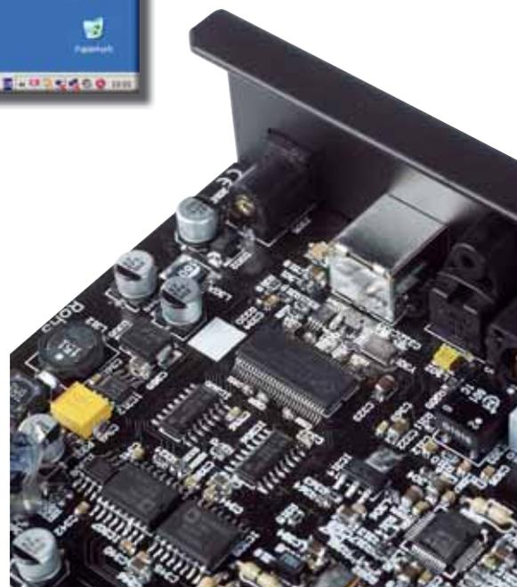
Der Chip im Hintergrund ist maßgeblich an der Fähigkeit des Wandlers beteiligt, USB-Signale asynchron zu empfangen
