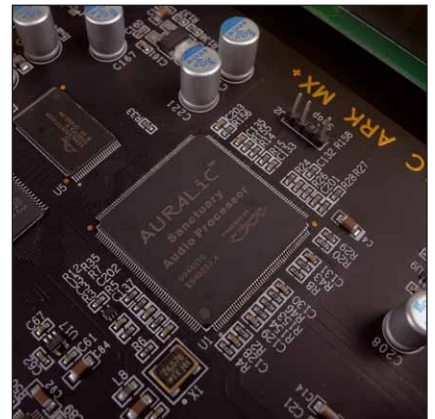
Der Prozessor detektiert die anliegende Signalfrequenz und veranlasst den Upsampler, die passende Samplingfrequenz zu benutzen
