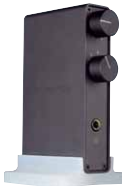
Neben dem Rechner sieht's so hübscher aus: Der NuForce steht aufrecht auf einem Gummifuß. Die Quellenwahl schaltet zwischen USB, „normalen“ Digitaleingängen und dem Analogeingang um
