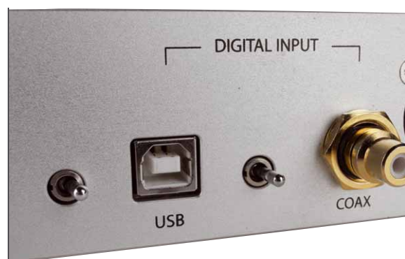
Die Quellenwahl zwischen USB und elektrischem Digitaleingang übernimmt ein kleiner Schalter
