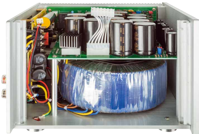
Der da unten, der ist ernst: Unten in der Endstufe steck ein echter Kochtopf von Transformator
