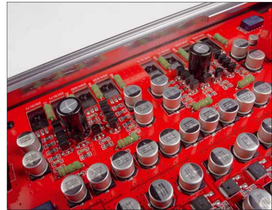
Die potente Class-A-Ausgangsstufe nutzt das ganze Gehäuse als Kühlkörper
