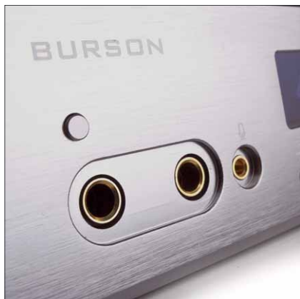
Zwei große Klinkenbuchsen dienen dem Kopfhöreranschluss, eine kleine ist für ein Mikrofon gedacht
