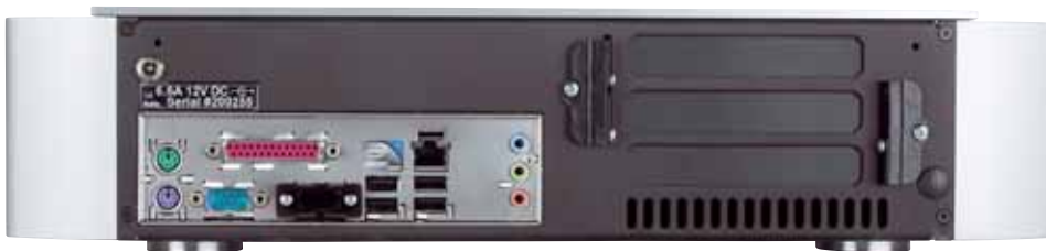
Hinten befindet sich der Ethernet-Anschluss und noch mal vier USB-Buchsen, an die man externe Speicher hängen kann
