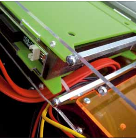
Die Festplatten sind eh schon leise, aber zusätzlich noch schwingungsdämpfend gelagert. Die hört man echt nur, wenn man es unbedingt will
